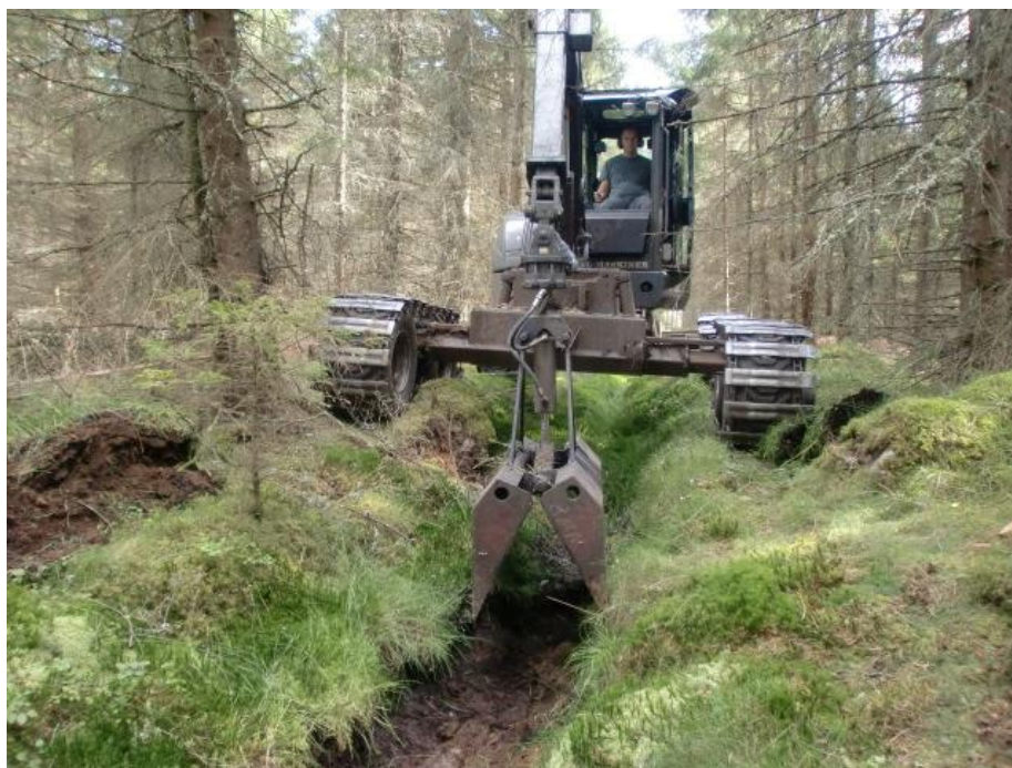
1.attēls. Inovatīva pieeja meliorācijas sistēmu uzturēšanai Zviedrijā – Varanen meža mašīna. Foto: Anja Lomander.
