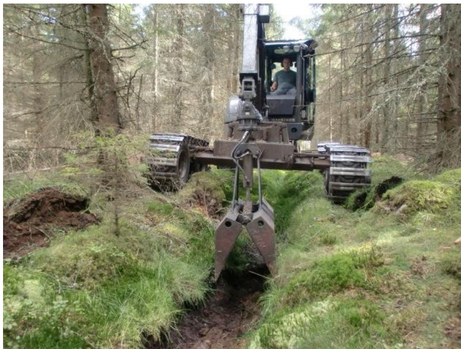
Kuva 1. Uusi kevyt ruotsalainen kunnostusojituskone "Varanen". Kuva: Anja Lomander.
