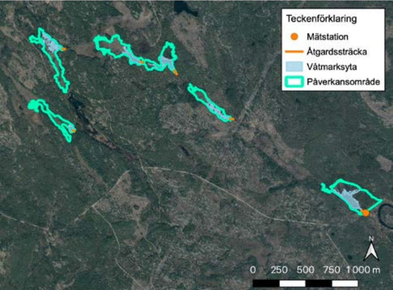
Restaureringsåtgärder av olika omfattning har genomförts på sex platser i Sandvadsbäcken under 2022 och 2023. Vid åtgärdsområdet längst nedströms (i sydost) ligger den trumma där flödesmätning pågår sedan maj 2020.
