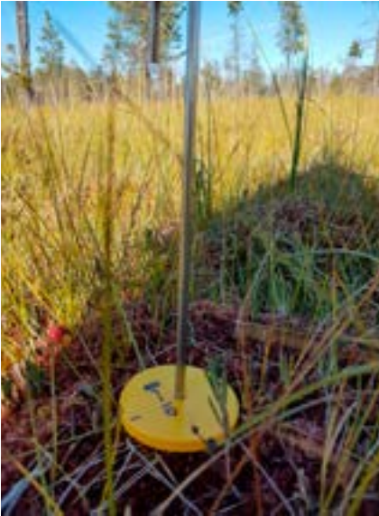
Mätpinnarna i vitmosseundersökningarna utgjordes av en metallpinne med en plastskiva som markerade var vitmossans ytskikt var då pinnarna sattes ut 2019. Mätningarna av vitmossans tillväxt utfördes därefter under tre år.
