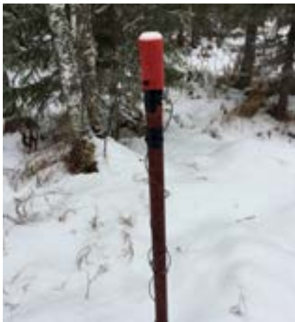
En högre vattennivå är oftast det främsta syftet med en våtmarksrestaurering. För att ta reda på om åtgärderna fått önskad effekt kan grundvattennivån mätas med hjälp av ett grundvattenrör.
