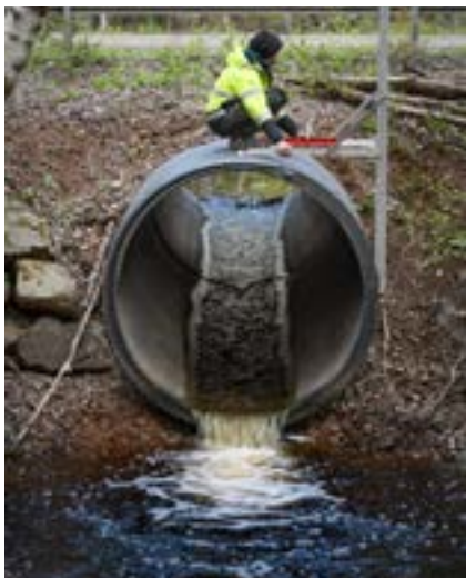
Vid vägtrummor mäts vattennivån relativt trummans ovkant medan man i diken måste sätta fast någon form av fast referenspunkt eller mätsticka att mäta emot, en så kallad pegel.
