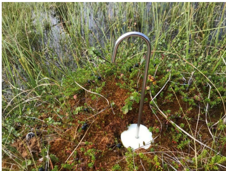
Figur 17. Metallpinne med plastplatta som använts vid pilotförsöken med tillväxtmätning av vitmossa.
