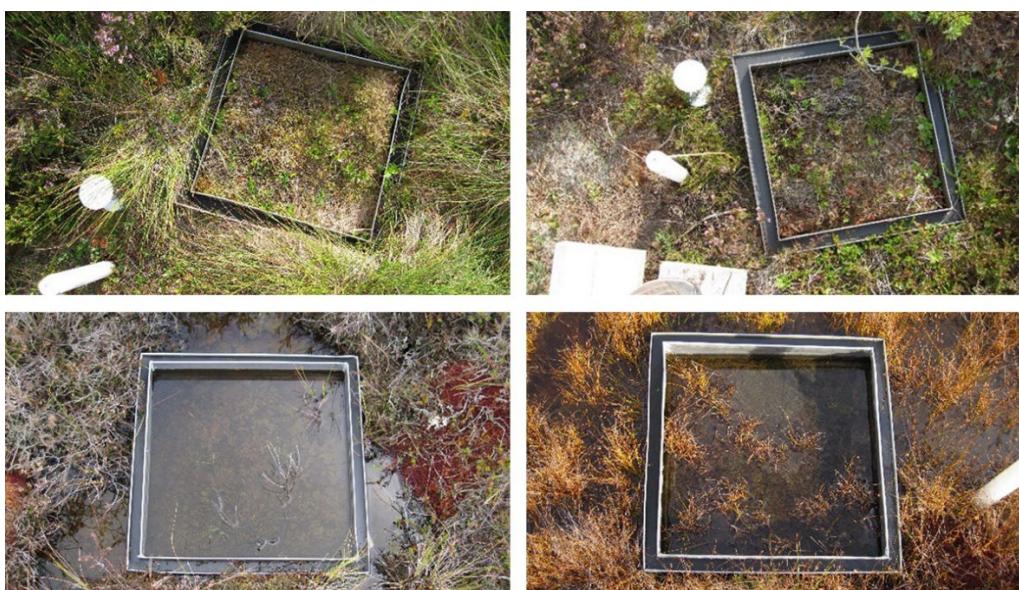
Figur 24. Anderstorps stormosse. Överst ram 5 och 9 dominerade av mossa på restaurerade ytan. NEE -0,09 och -0,06 \text{ g CO}_2 \text{ m}^{-2} \text{ h}^{-1} i medeltal vid mättillfällena. Nedre bilder visar ram 17 och 23 från referensytan. NEE -0,02 och -0,002 \text{ g CO}_2 \text{ m}^{-2} \text{ h}^{-1} i medeltal vid mättillfällena.
