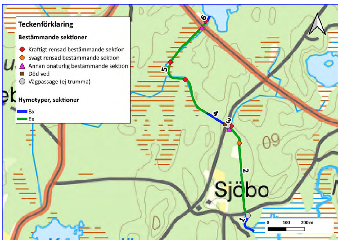
Figur 118: Karta över Skärsjöbäckens delsträckor och färgkodning utefter delsträckornas hymotyper samt förekomsten av bestämmande sektioner indelade i kategorier.
