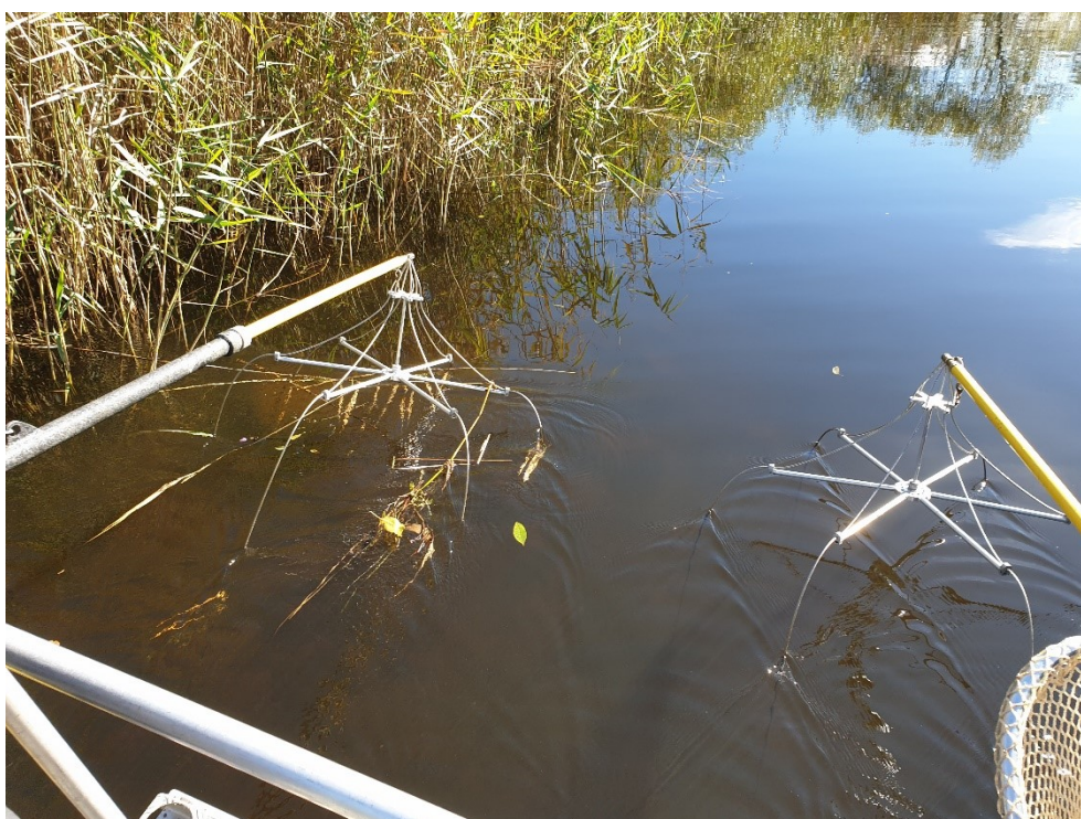
Figur 3. Anoderna som hänger delvist nedsänkta i vattnet framför fören.
