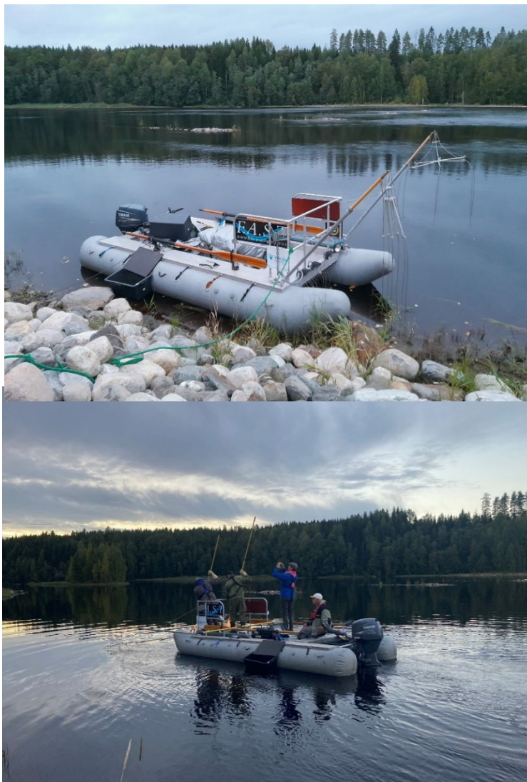
Figur 1a och 1b som visar elfiskebåt av modell Catacraft. Foton: Övre Matti Janhunnen (Luke). Nedre Helena Haakana (ELY-keskus).
