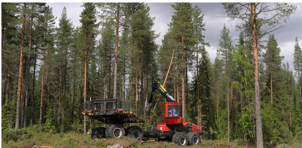
Drivaren avverkar, kvistar, kapar, lastar och kör ut virket till skogsbilväg. Den förenar skördaren och skotaren i en maskin. Norsjö, Västerbotten.
