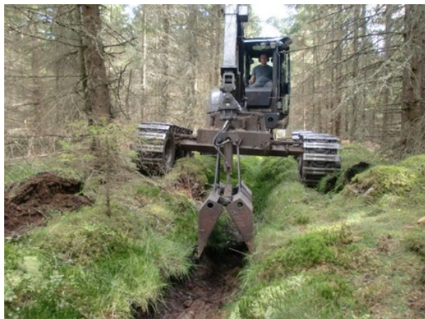
Figur 17. Specialbyggd maskin utrustad med gripskopa rensar dike på torvmark. Bandbredden kan varieras. Få träd behöver avverkas för att maskinen ska ta sig fram. Foto: Anja Lomander.
