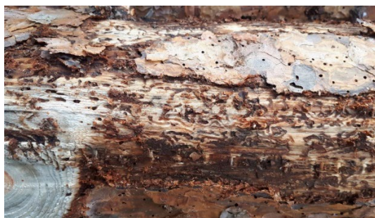
Bild 27. Tallstock med tydliga tecken att ha angripits av skarptandad barkborre. Blånad, tydliga gångar i splinten och utgångshål i glansbarken. Foto: Mats Carlén.
