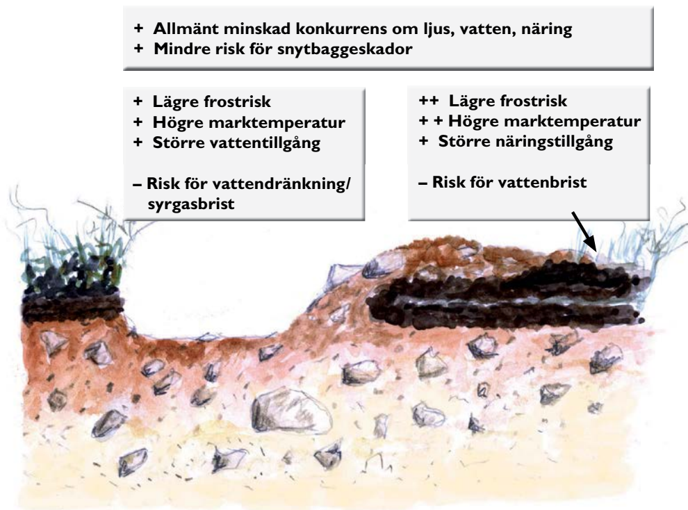
Figur MV9 Grov karaktärisering av planteringsmiljöer som skapas vid maskinell markberedning (harvning – profil tvärs körriktning; högläggning – profil längs körriktning). Angivna effekter är i jämförelse med ej markberedd planteringsmiljö. Illustration Bo Persson
