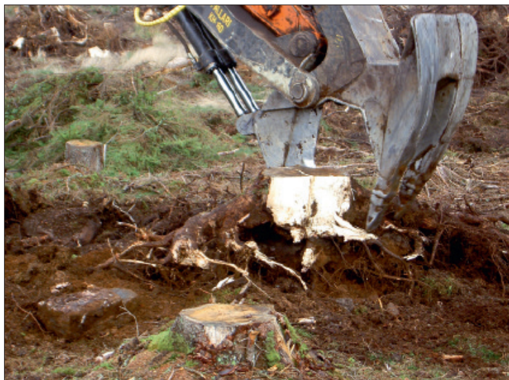
Klippande stubbskördsaggregat som klipper stubben i delar innan den tas upp.
