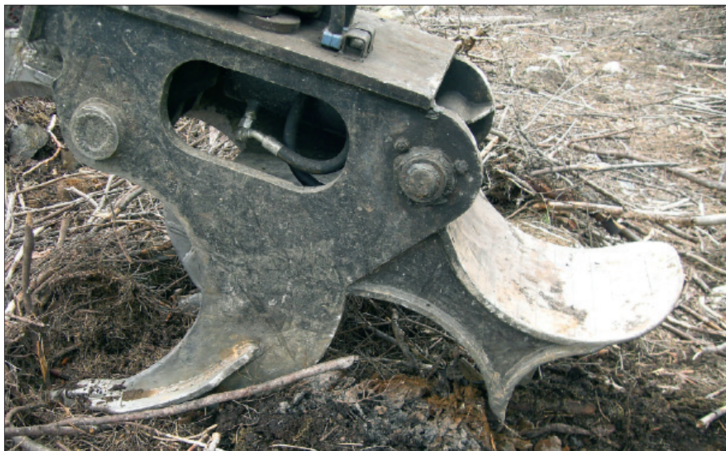
Markberedning med stubbskärningsaggregat.
