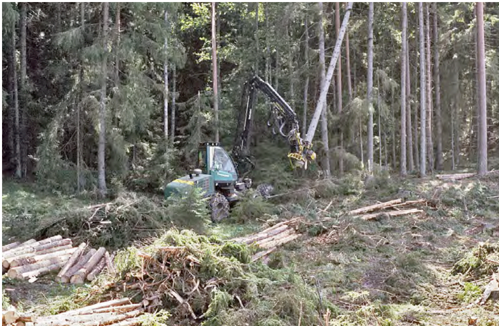
Figur S5 Mekaniserad slutavverkning med hjälp av skördare. Foto Erik Valinger.
